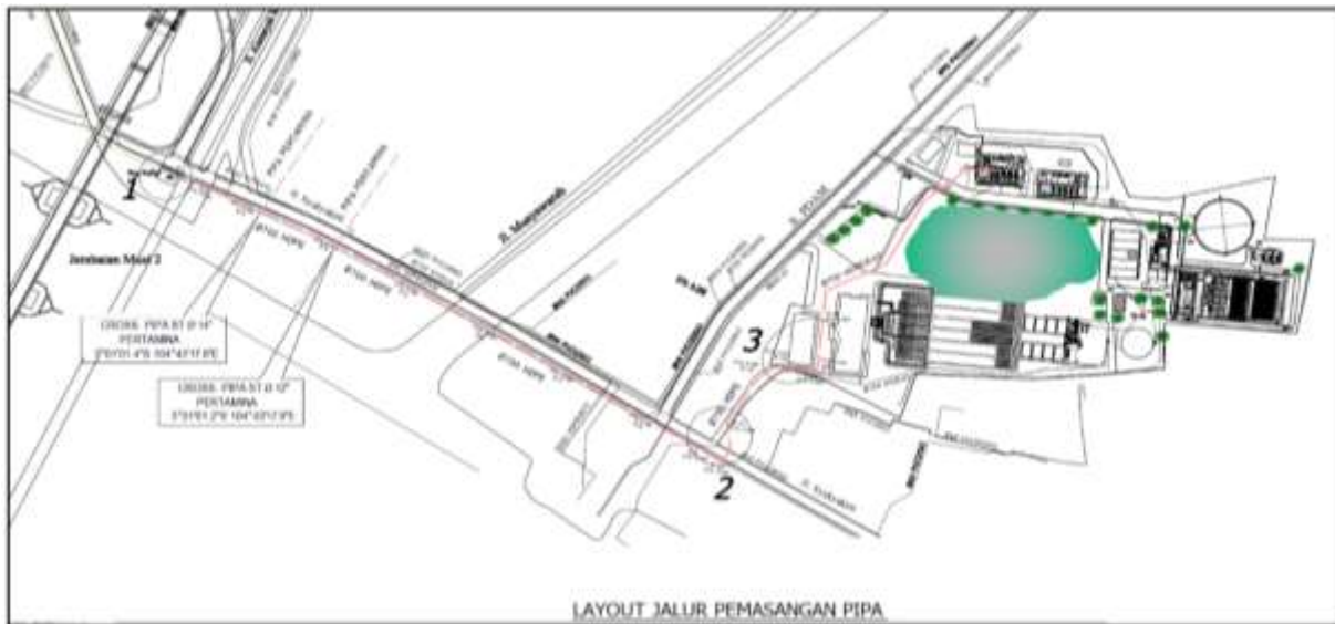
Gambar 11. Layout Jalur Pemasangan Pipa Diameter 700 mm
