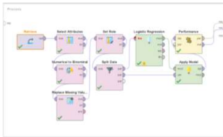
Gambar 1. Alur Proses Menggunakan Logistic Regression pada Rapidminer
