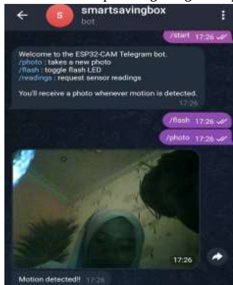
Gambar 5. Tampilan ESP32-cam yang mengirim gambar ke telegram.
