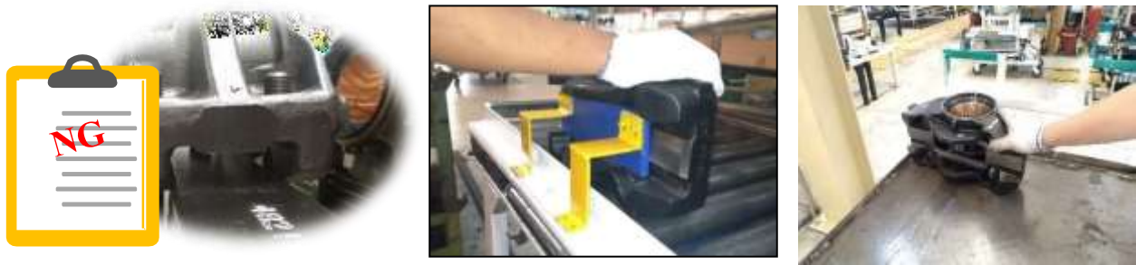
Gambar 2. Hasil barang NG, lalu di bantu dengan alat Go Nogo JIG Dummy , dan produk OK Sumber: Analisa data PT XYZ (2022)
