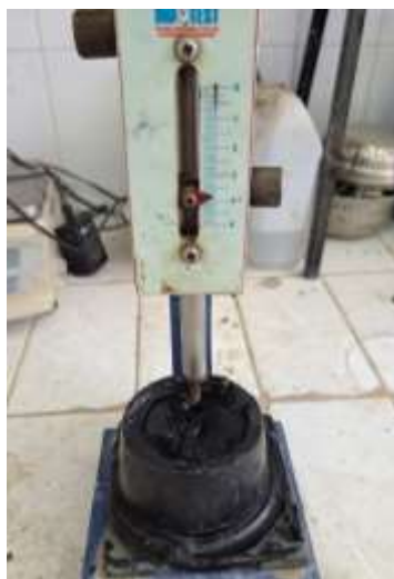
Gambar 6. Pengujian Setting Time Abu Ampas Tebu Sumber: Penulis
