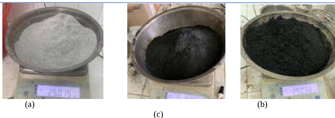
Gambar 1. Material Limbah Organik, (a) Abu sekam padi, (b) POFA, (c) Abu ampas tebu Sumber: Penulis
