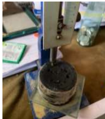
Gambar 5. Pengujian Setting Time POFA Sumber: Penulis
