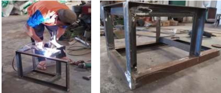
Gambar 7. Proses penyambungan plat dan kerangka mesin pencacah kompos PPO-100E Sumber: Analisa data pada PT. XYZ
