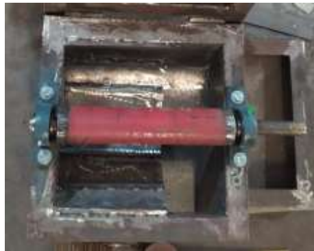
Gambar 15. Pemasangan poros pada kerangka Sumber: Analisa data pada PT. XYZ
