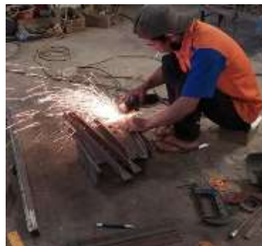
Gambar 6. Proses pemotongan plat pada PT. XYZ Sumber: Analisa data pada lapangan
