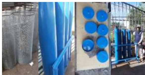
Gambar 4. Bentuk Saringan, Tabung Penyaring Penutup Tabung dan Dudukan
