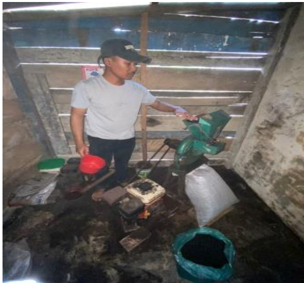
Gambar 5: Proses penggilingan kopi dengan mesin untuk penghasilan bubuk kopi
